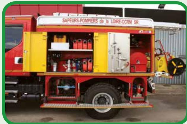
Cet engin, monté sur un châssis Renault Midlum 4x4 d'une puissance de 270 CV, correspondant à la dernière génération des CCR classiques. La nouveauté de ce véhicule est l'aménagement du côté gauche, armé en matériel d'incendie et du côté droit, en matériel de secours routier. Il dispose d'un mât télescopique d'éclairage avec des lampes au Xenarc tandis que l'éclairage du véhicule s'effectue par des lumières Leds.
