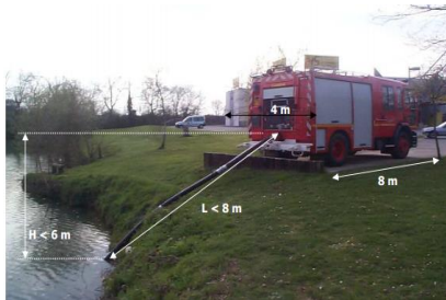
Aménagement d'une réserve d'eau naturelle
